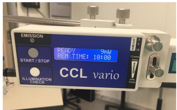
Figura 4. Emisor de radiación ultravioleta programado para un tratamiento acortado de 10 minutos a 9 mW.
