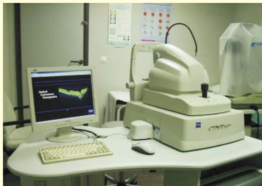
Este aparato utiliza una fuente de luz láser de baja coherencia de 820 nm de longitud de onda de 750 microwatios<sup>24</sup>, generado por un diodo superluminescente. Penetra unos dos milímetros en la retina y hace un corte transversal de varios milímetros mediante los ya comentados sistemas de interferometría, muy avanzados y computerizado. De este modo se logran cortes axiales bidimensionales, con una resolución de unas diez micras en los primeros modelos.
